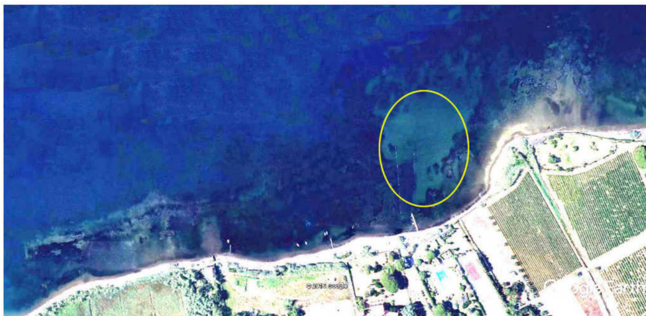
Fig. 5 - Foto satellitare dei fondali fortemente contrastata. Il fondale delimitato in giallo è più profondo dei fondali adiacenti di 1,5-2m, proprio in corrispondenza della zona più critica (crollo del 2017); in superficie è costituito interamente da sabbia, che a intervento eseguito potrebbe spostarsi stabilmente verso riva.
