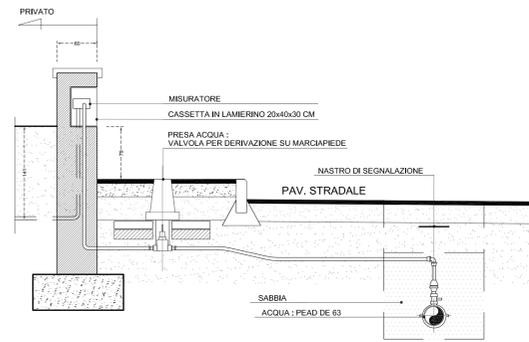
PARTICOLARE TIPICO POZZETTO CON VALVOLE DI INTERCETTAZIONE
