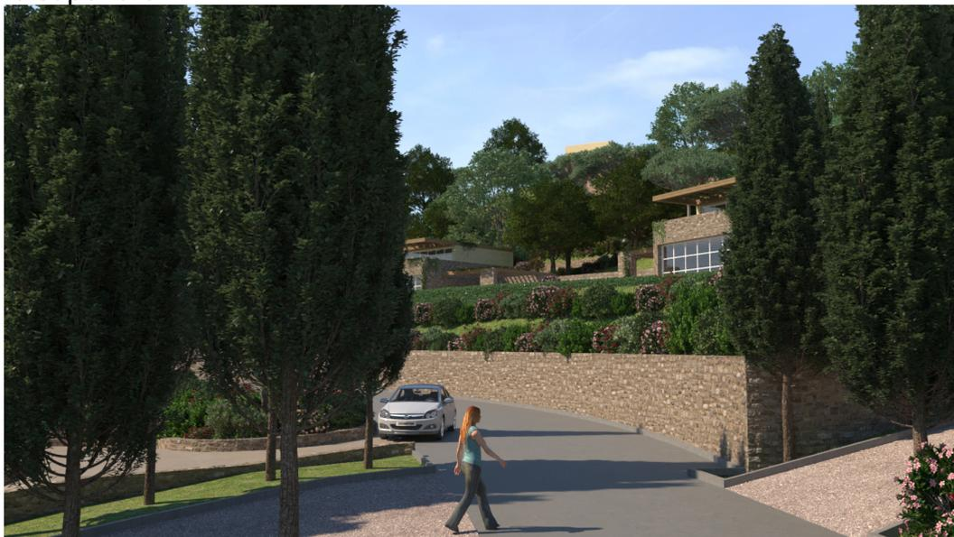
3- Il rapporto con il terreno. Dove le pendenze sono più accentuate si dovranno utilizzare dei corpi di fabbrica a prevalente sviluppo trasversale rispetto alle pendenze, in modo da limitare le necessità di sbancamento e di aggetto/ riporto. In questi casi si potrà avere un affaccio “cieco” in modo che il fabbricato possa essere addossato ad uno “scasso” del terreno emergendo il meno possibile dal crinale.
