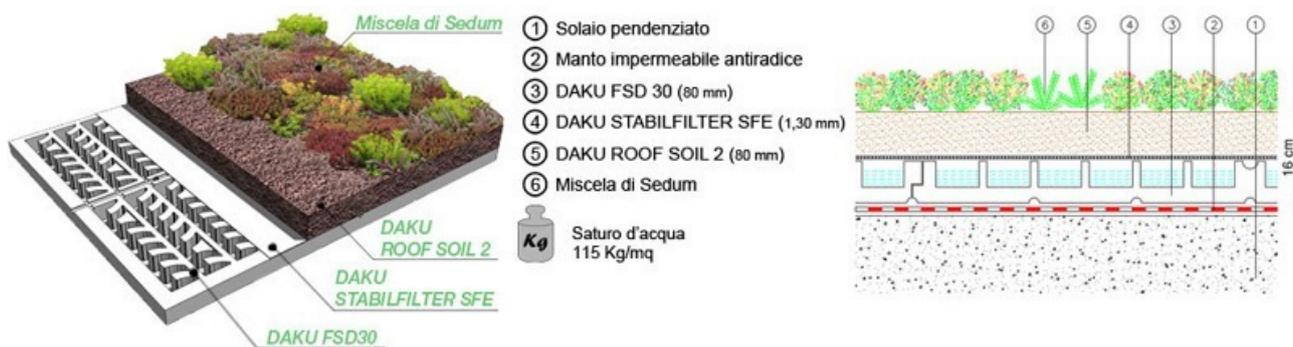
Il tetto verde in progetto è un tetto verde di tipo estensivo ricoperto interamente con piantine di *Sedum*. Il sistema DAKU (in figura) è uno dei tanti sistemi professionali che fornisce indicazioni e materiali per realizzare un tetto verde. Le varie stratificazioni sono necessarie per rendere il tetto verde drenante e allo stesso tempo isolato da ciò che si trova al di sotto, fornendo così tutta la serie di vantaggi sopra descritti.
