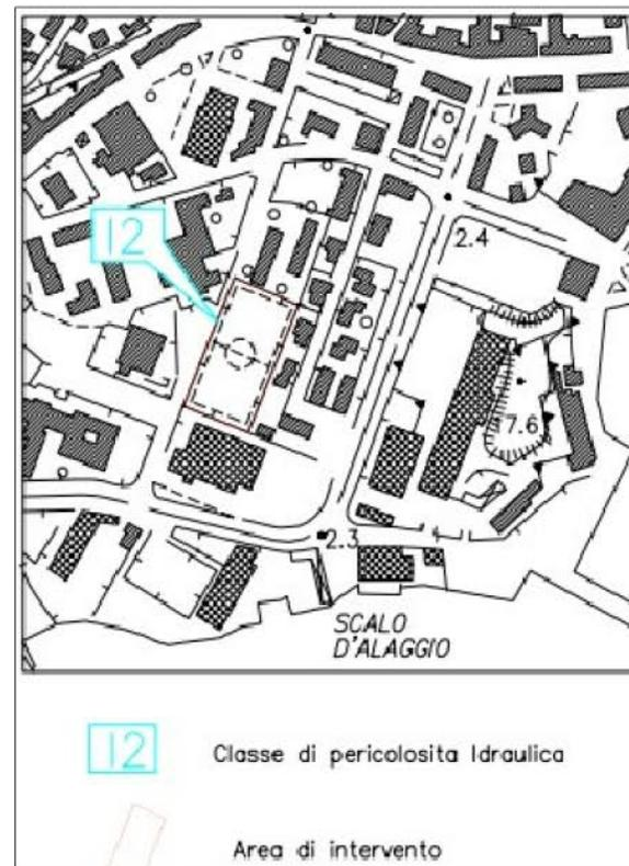
La figura, estratta dalla carta della pericolosità da alluvione del Piano di Gestione Rischio Alluvioni dell'Autorità di Distretto Appennino Settentrionale, individua una pericolosità da alluvione CLASSE 1 paragonabile, ai sensi del LR 41/2018, con una Pericolosità Idraulica media I2 di cui al D.P.G.R. 53R/2011. Per attribuirne la fattibilità idraulica NON saranno effettuate verifiche idrauliche sul reticolo interferente di cui alla L.R. 79/2012.
