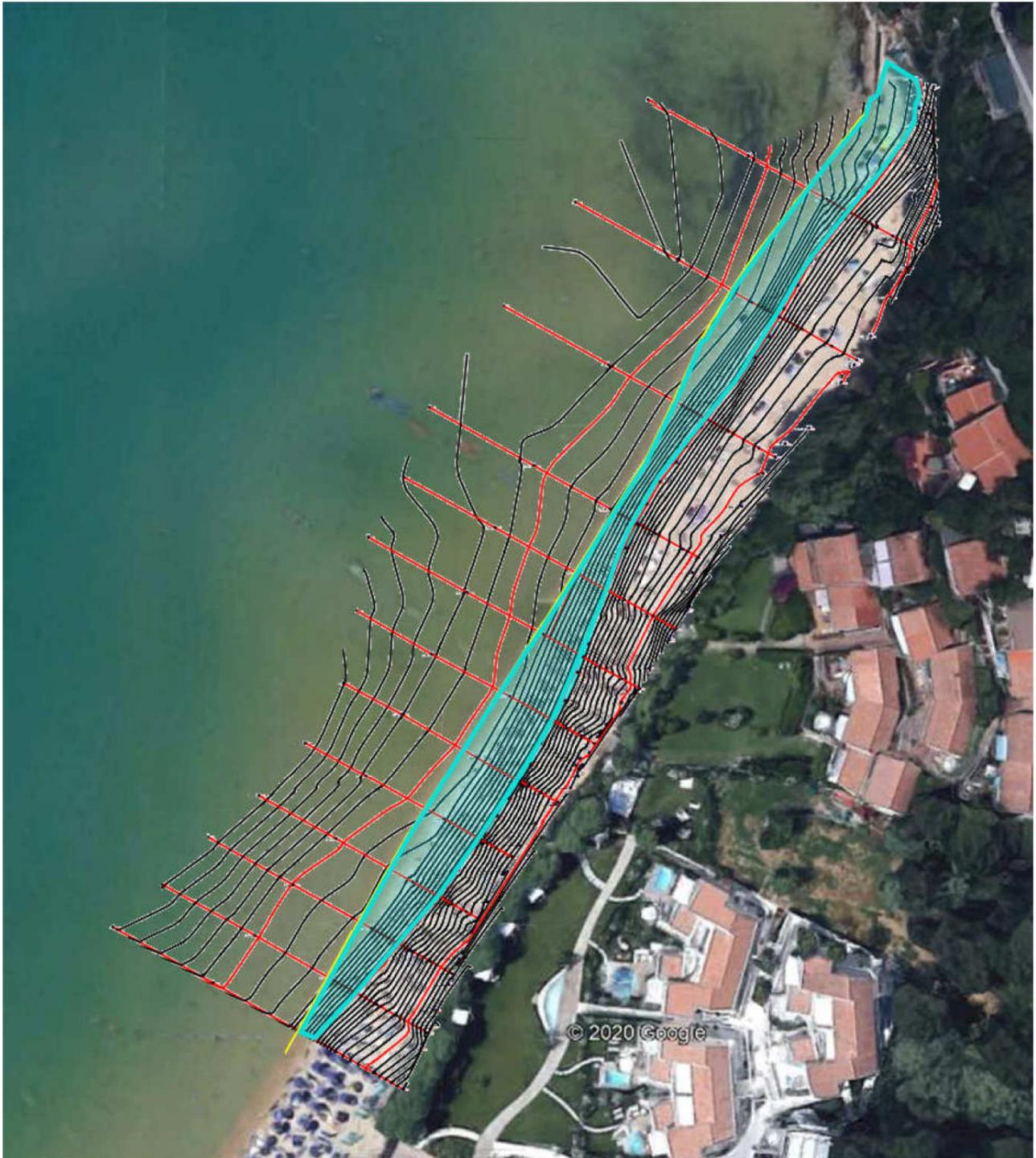
Fig. 5 – Erosione della spiaggia della Biodola, lato Nord. La sovrapposizione del rilievo e della linea di riva attuale sul **satellitare del 2018** evidenzia i punti più in crisi, sui quali è urgente intervenire, in attesa di un intervento più incisivo. *La perdita di superficie di spiaggia (zona celeste) **in soli due anni** è di circa il 40%*
