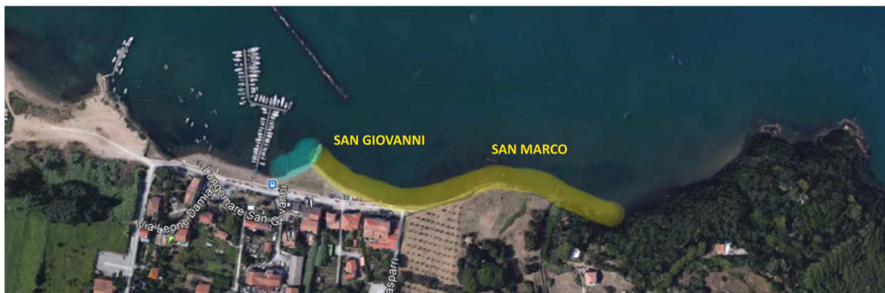
Fig. 2 – Le porzioni di costa a San Giovanni e San Marco oggetto di monitoraggio. In giallo i tratti oggetto del ripascimento e di protezione, in celeste quello limitrofo, oggetto di un limitato asporto dei sedimenti in eccesso a favore della spiaggia ad E.
